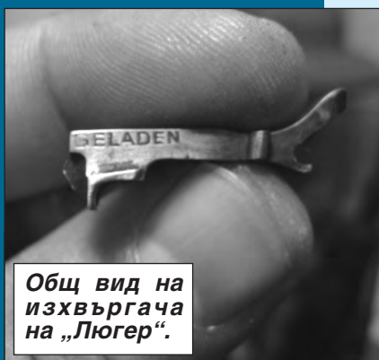
Изхвъргачът на „Люгер“ е разположен централно на затворния блок.
