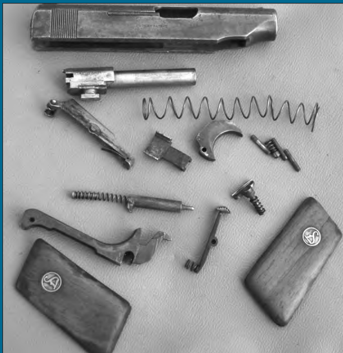
Частите на самозаряден пистолет „Deutsche Werk Orgtjes“, произведен в Ерфурт, Германия, 1921 година
